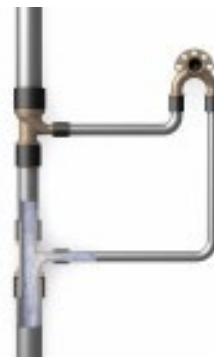
Кольцевая система водоснабжения
